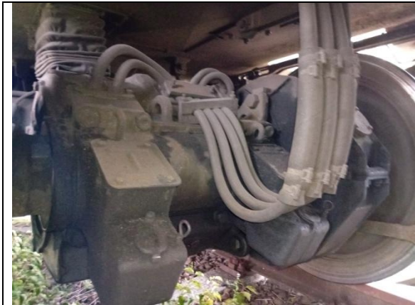
Trakčný motor TE 015, tlapové ložiská , prívodné vodiče a zákryt trakčného prevodu
