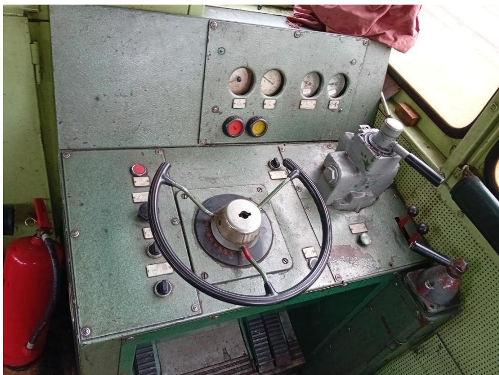
Meracie prístroje a ovládače na riadiacom pulte II. stanovišťa
