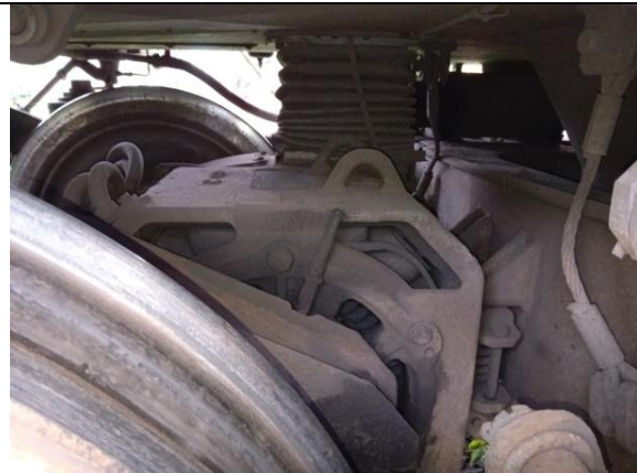
Trakčný motor TE 015 s mechom prívodu chladiaceho vzduchu od ventilátora chladenia
