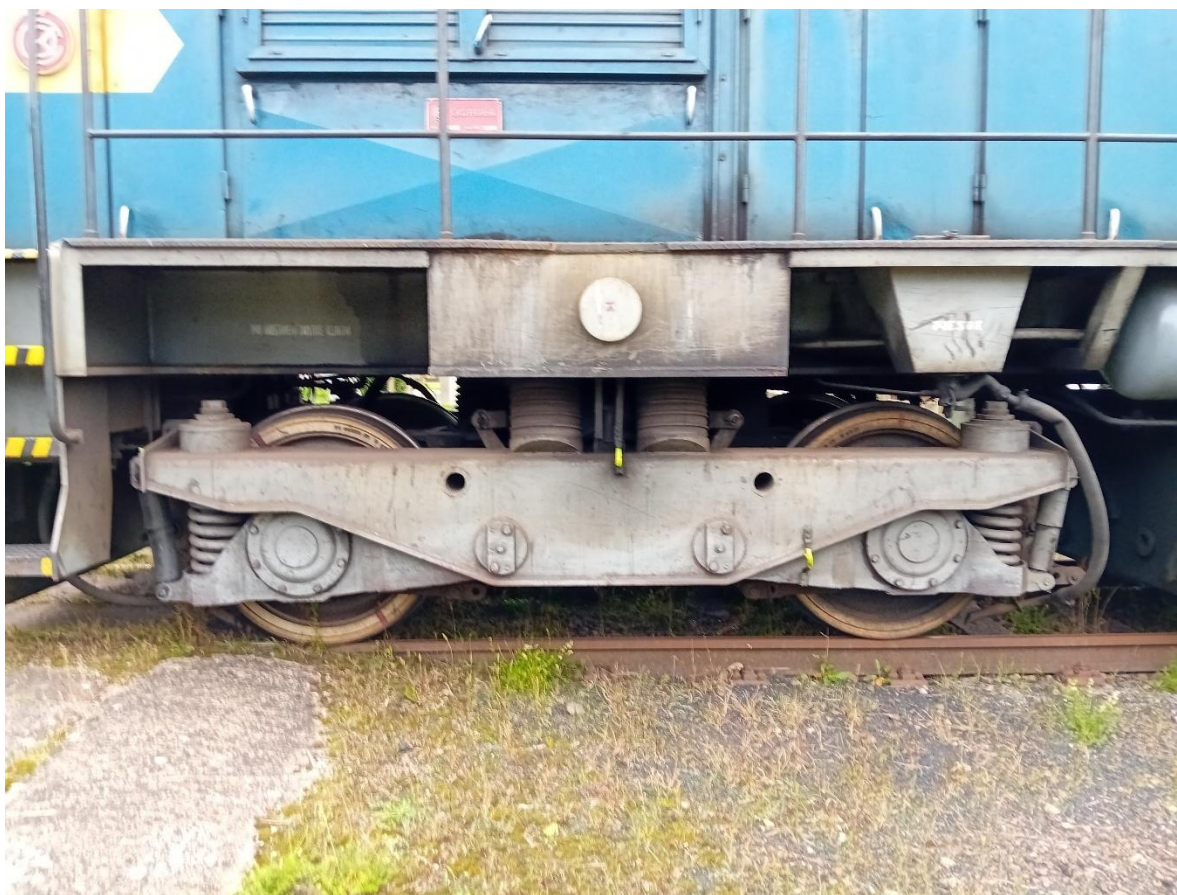
Predný podvozok motorového rušňa T 448.0714 ľavá strana
