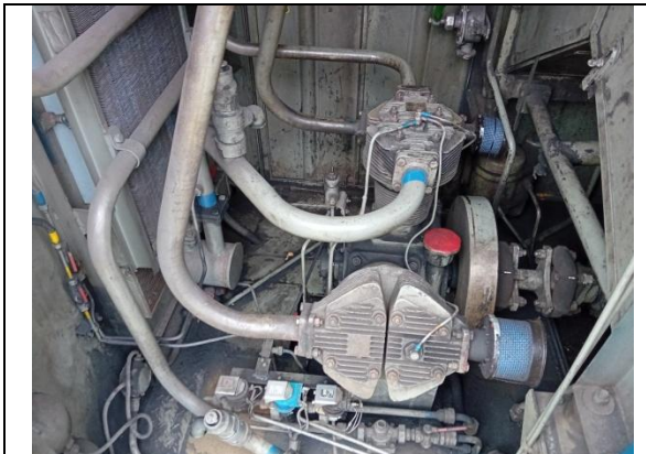
Kompresor K3 Lok1
