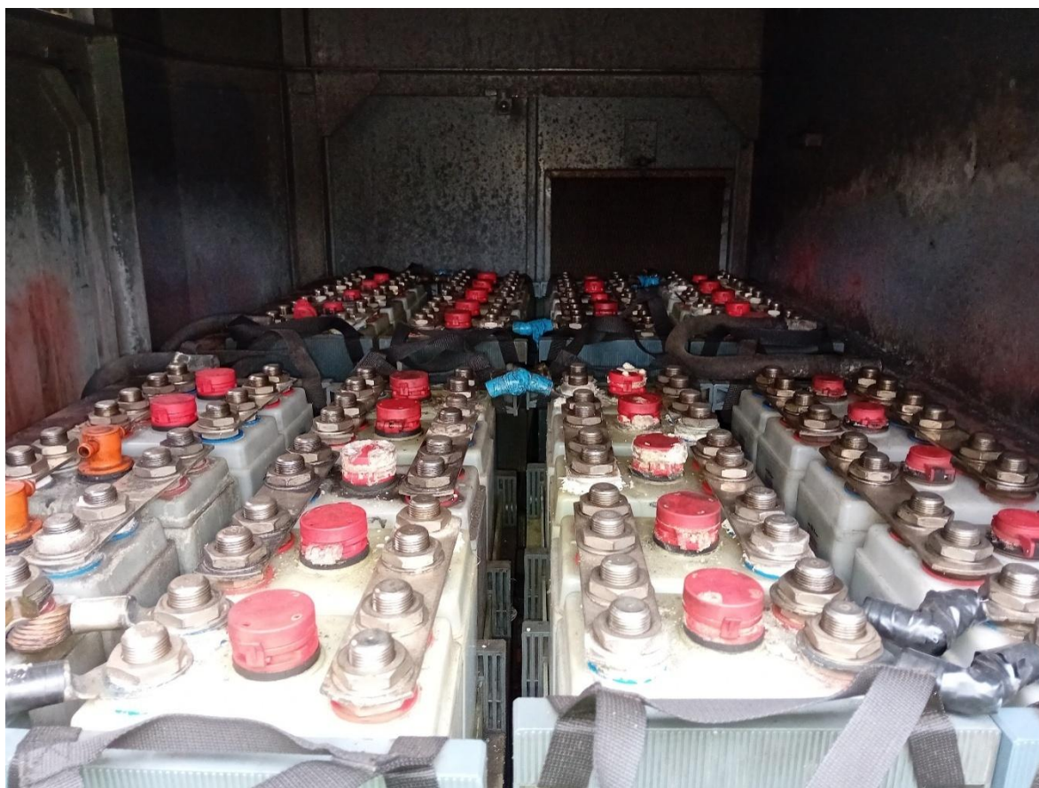
Akumulátorové batérie KPH 150P lokomotívy T 448.0714
